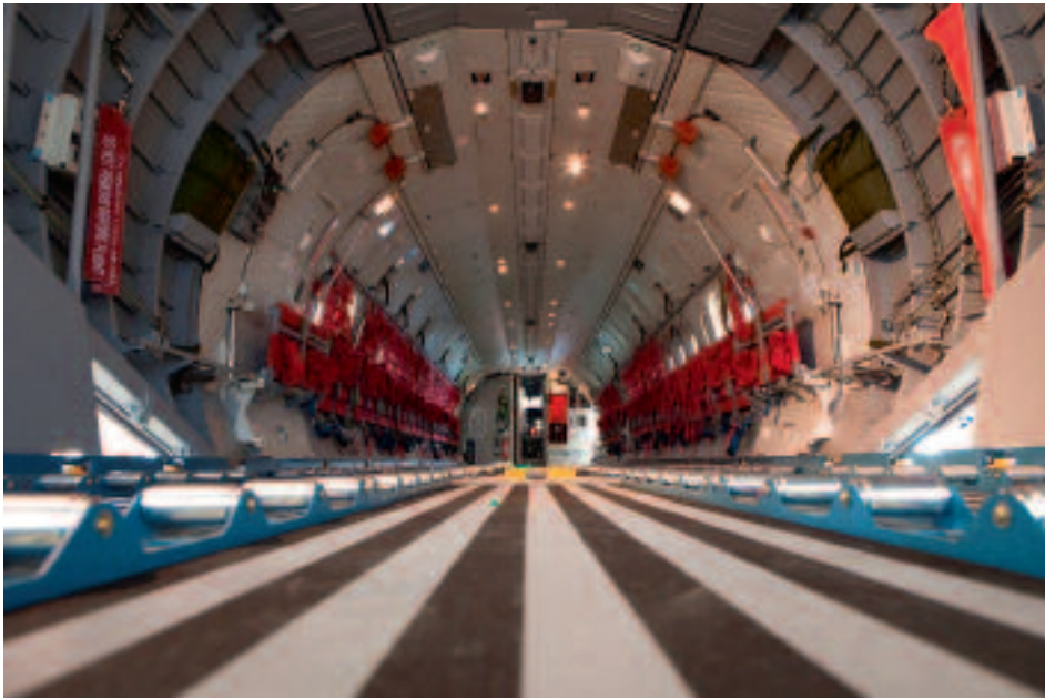
Un sistema de manejo de cargas guía los pallets hasta su posición en la cabina donde se bloquean manualmente.
