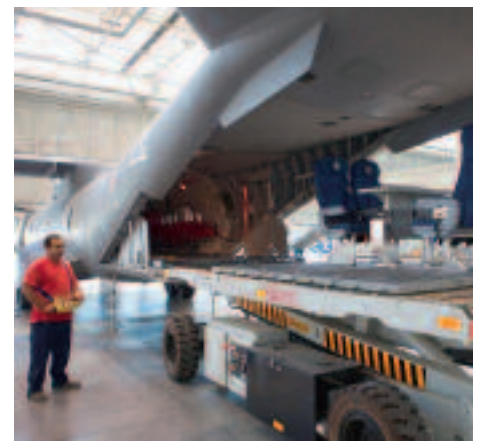
Gran versatilidad: los pallets se cargan por la rampa trasera del avión permitiendo múltiples configuraciones.
